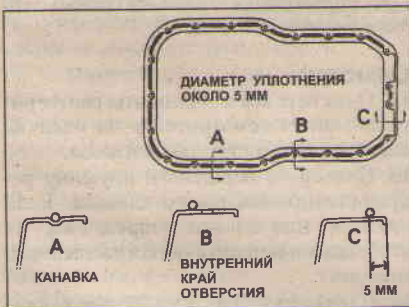
14.14 Нанесите полоску герметика на фланец поддона
