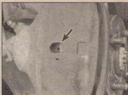
16.6 В каждом суппорте имеется смотровое отверстие, подобное этому - используя стальную линейку, можно определить толщину оставшегося материала тормозных колодок
