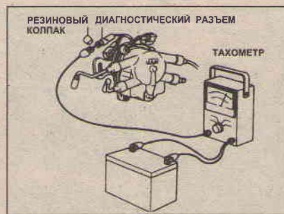
34.3а Схема соединения тахометра - двигатель 2-SE 1986 г. выпуска
