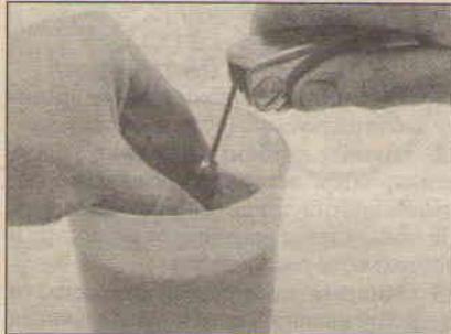
10.18 Погрузите регулятор зазора в контейнер с маслом, вставьте пробойник в отверстие плунжера, нажмите контрольный клапан и несколько раз прокачайте плунжер вверх-вниз
