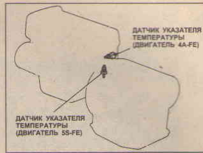
9.3b ... На двигателях 4A-FE и 7A-FE датчик установлен выше крышки распределителя
