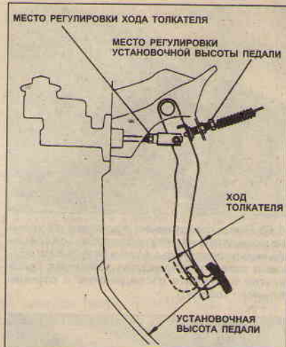
10.2 Регулировка зазора штанги толкателя и свободного хода педали сцепления: ослабьте контргайку и вращайте штангу толкателя. Регулировка установочной высоты педали: ослабьте контргайку и вращайте ограничительный болт
