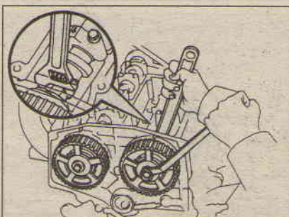
7.25 Снимите клапанную крышку и, по очереди удерживая распредвалы гаечным ключом за шестигранник, ослабьте болты шкивов
