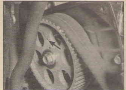
7.11a На двигателях 3S-FE и 5S-FE, проверните коленвал, чтобы отверстие в шкиве распредвала (стрелка) оказалось вверху...
