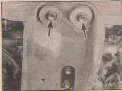
14.7b Открепите передний кронштейн и открутите два болта крепления подмоторной рамы (стрелки)
