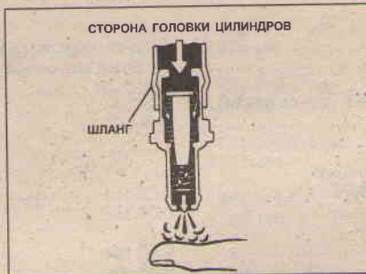
35.4 Подсоедините шланг к клапану со стороны головки цилиндров - воздух через него должен свободно продуваться, а в обратную сторону нет
