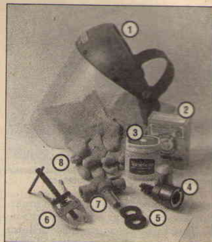
11.1 Инструменты и материалы, необходимые для обслуживания аккумулятора
